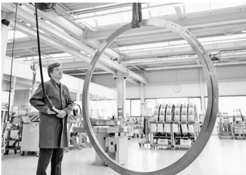
I cuscinetti in elementi Franke diventano disponibili come sistemi completi costituiti da cuscinetto, sistema di trasmissione e controllo con l'integrazione di motori direct drive. Nella parte statica del cuscinetto alloggia lo statore, mentre la parte mobile funge da rotore della trasmissione elettrica, senza ulteriori componenti.
