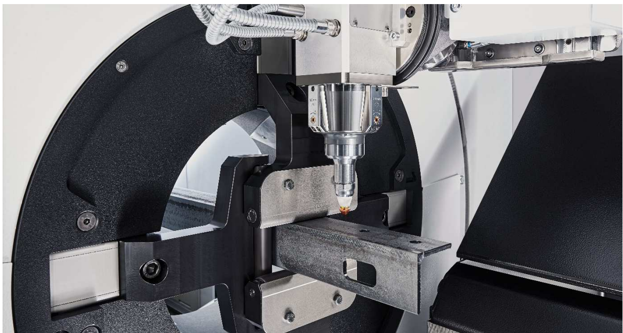
I cuscinetti Franke assicurano un preciso posizionamento dei componenti da lavorare
