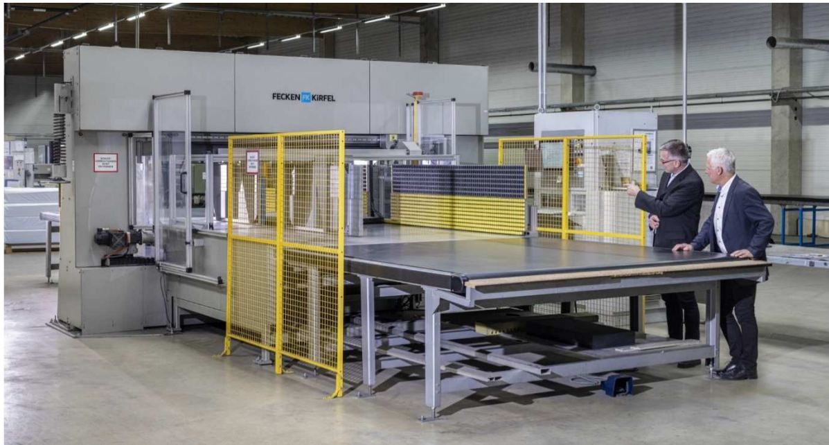
Immagine: Macchina per la contornatura verticale di Fecken-Kirfel in uso alla Polyfoam Kautschuk GmbH (Franke GmbH)
