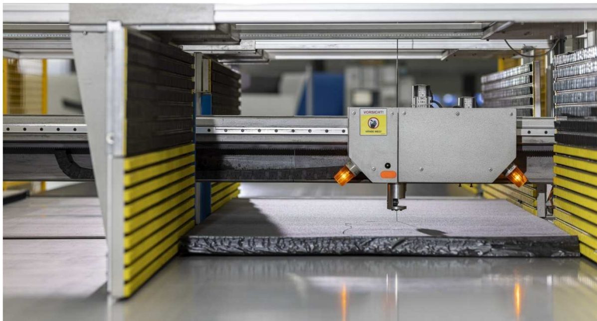
Immagine: L'affilata lama a nastro effettua tagli precisi su materiali schiumosi(Franke GmbH)
