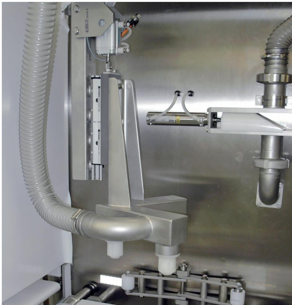
**La guida lineare serie FDC è particolarmente indicata per impieghi in ambienti umidi o sottoposti a lavaggi, come l'industria alimentare; esempio di applicazione in un impianto caseario.**
