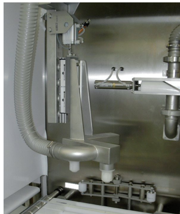
Esempio di applicazione della guida lineare in un impianto caseario
